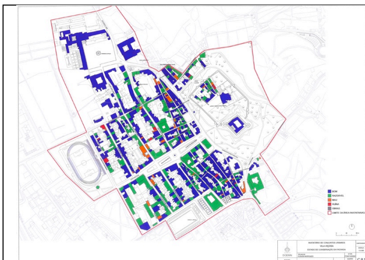
Figura 184. Vila Viçosa, Inventário do Conjunto Urbano, Estado de conservação das fachadas, DGEMN, 2006. A maioria dos imóveis apresenta um estado de conservação Bom (representado a azul) ou Razoável (representado a verde).
